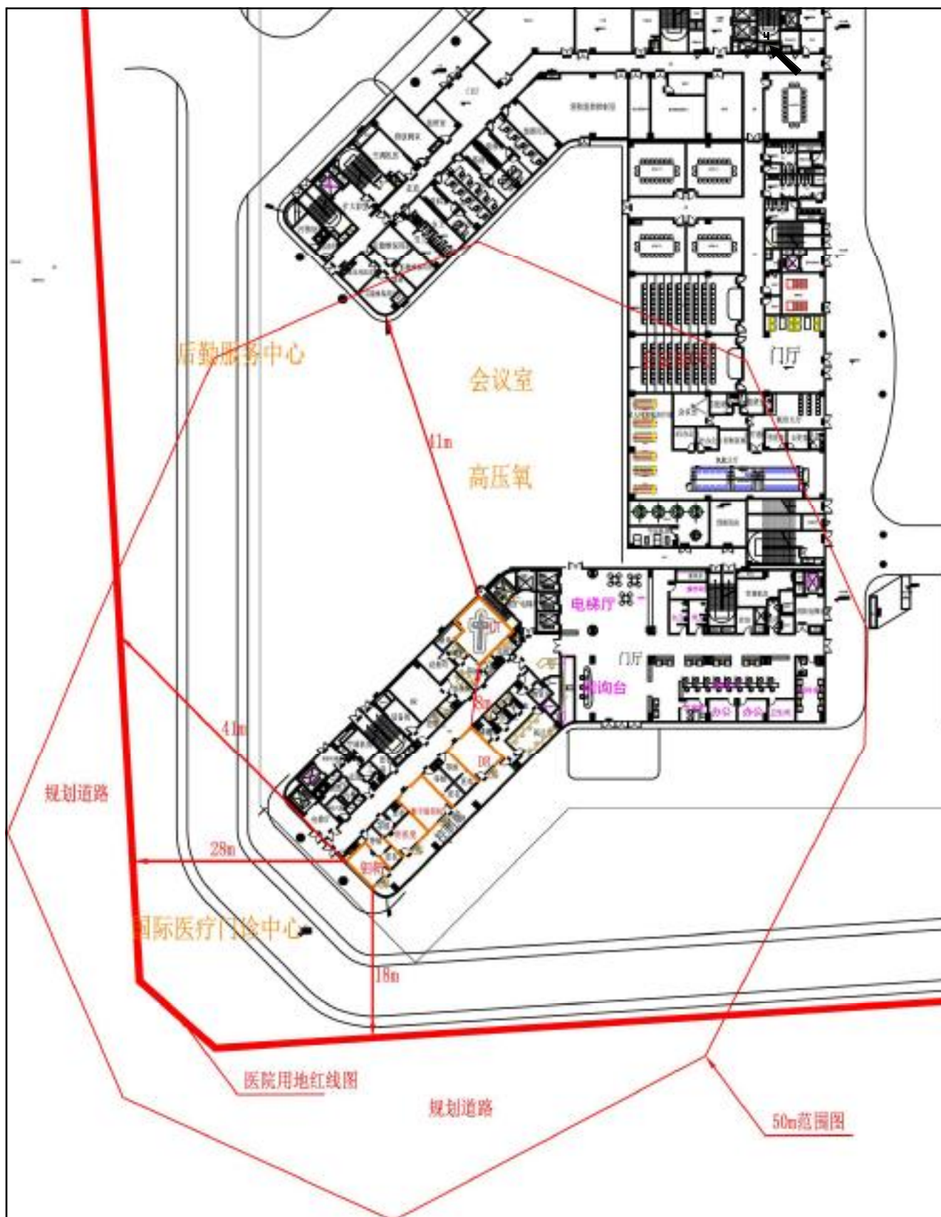
图 L-3-15 国际医疗门诊中心—核 CT、DR、数字胃肠机、骨密度仪、乳腺钼靶机机房 50m 范围关系图
